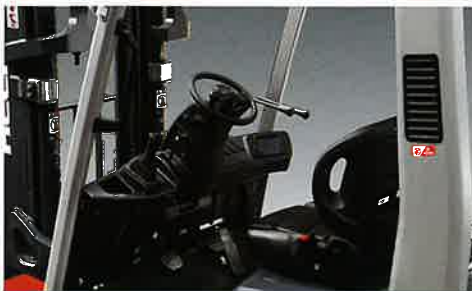
チルトシリンダーを低位置にレイアウトすることにより、下部プレートの上部スペースが増え、足元スペースが広がります。
